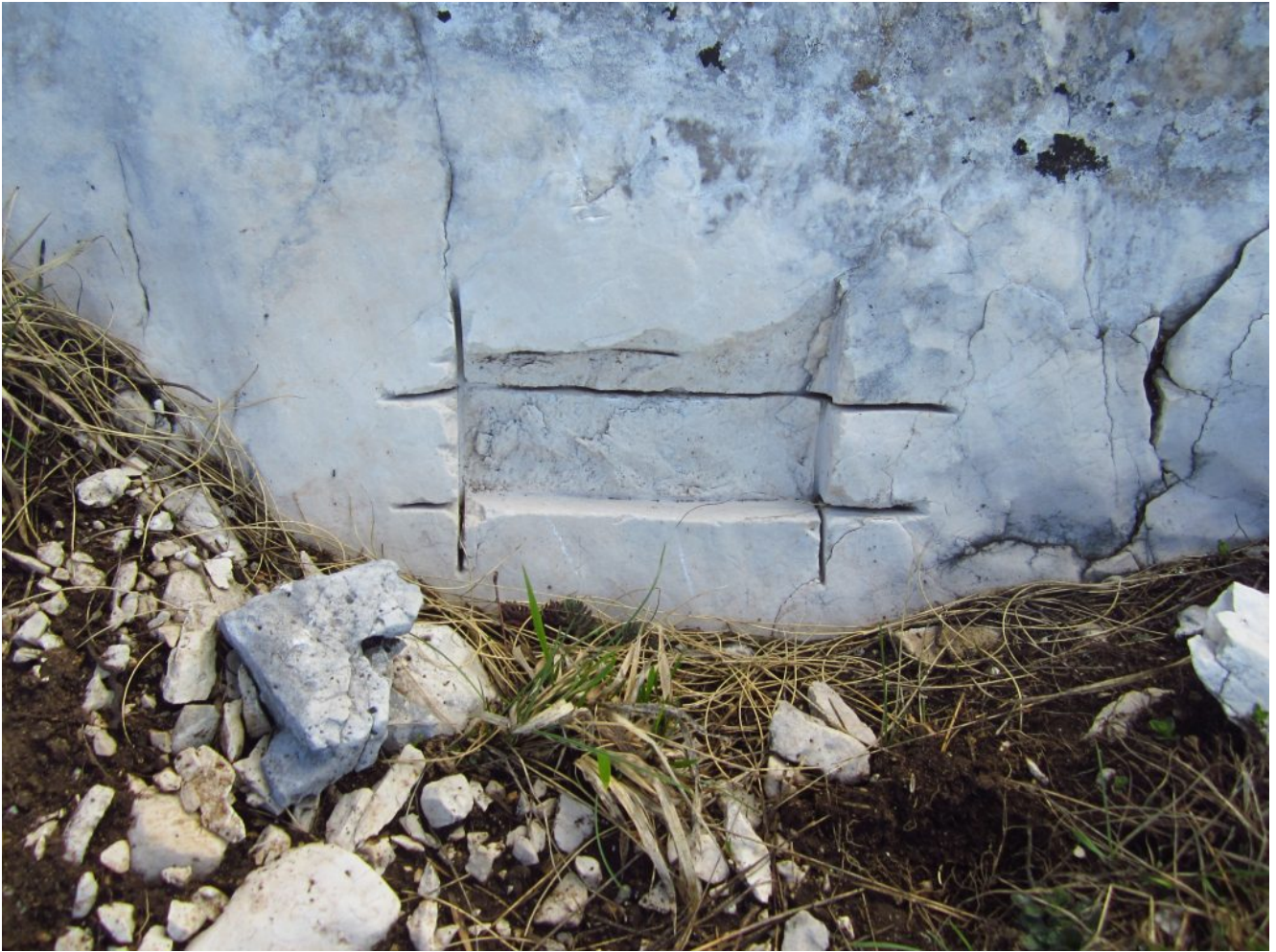
14- Su un tratto di roccia scoperta dall'abbassamento del terreno qualche geologo ha staccato un provino per studio.
