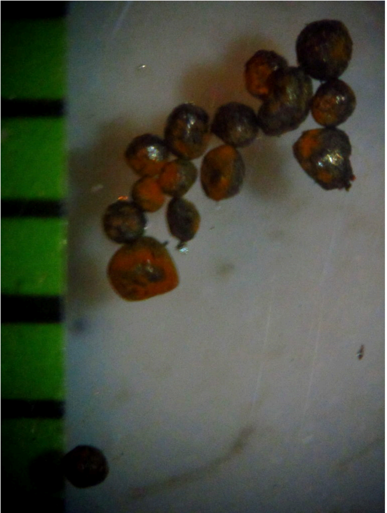
21- Sferule di netta provenienza antropica raccolte all'esterno di una industria, a poche decine di metri dalla bocca di uscita di un impianto di aspirazione da un reparto di saldatura articoli metallici, molto differenti dalle possibili
